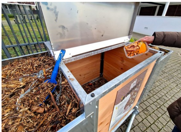
Figure 2 - Composteur grutable : à chaque dépôt de biodéchets alimentaires, le contributeur verse une poignée de matière structurante, située de part et d'autre du bac d'apport
